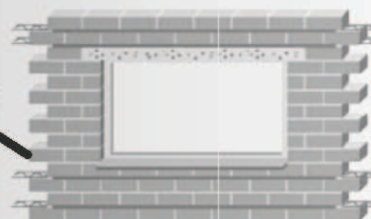
Linteaux, Baies de portes et de fenêtres
